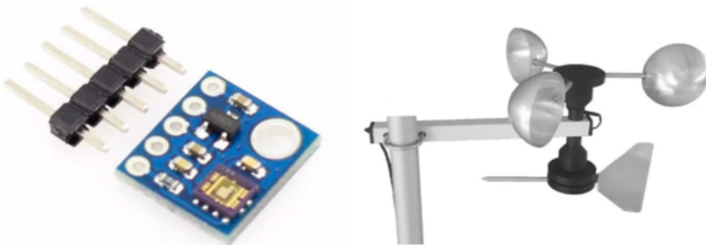
Figura 12 – Sensor de radiação ultravioleta modelo ml511 e anemômetro digital com biruta eletrônico
