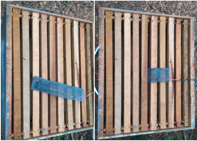
Figura 8 – Sensor dht 21 inserido entre os quadros 5 e 6, no centro da colmeia Fonte: Autor (2022)
