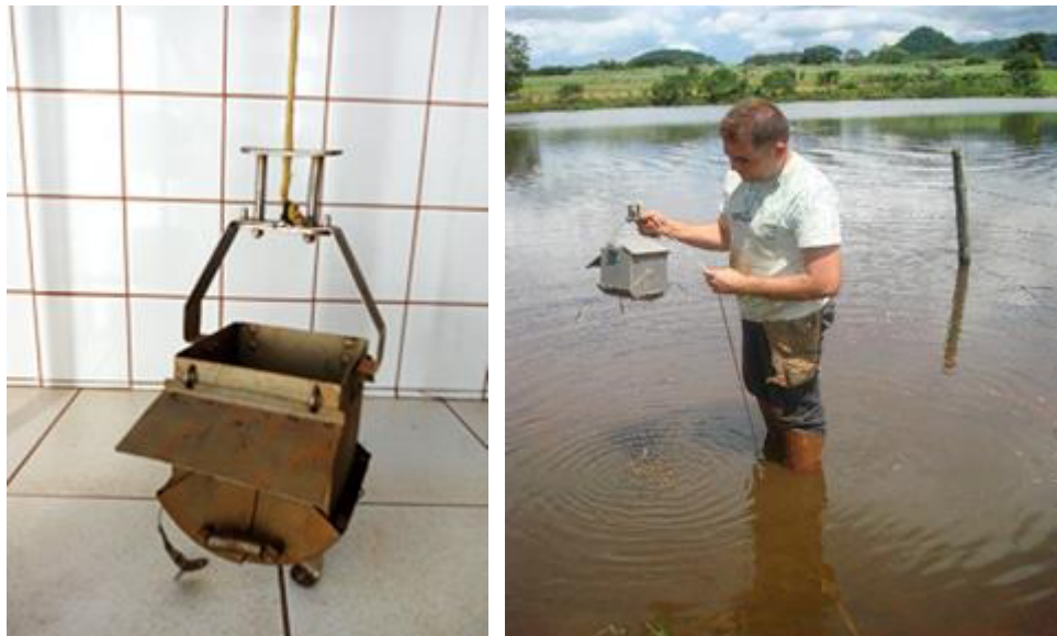
Figura 1.2 - Amostrador do tipo Draga de Eckman-Birge (área padrão de 255 cm 2 ).
