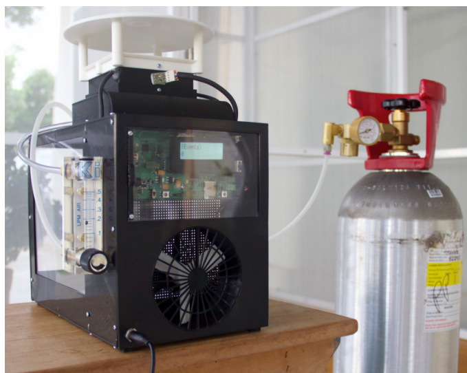
Figura 8.3 - Armadilha equipada com sensor óptico utilizada para contar e identificar espécies de mosquitos em tempo real.
