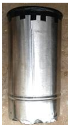
Figura 1.4 - Um exemplo de amostrador tipo core .
