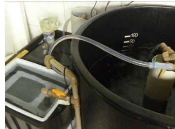
Figura 13 - Sistema de recirculação para produção de copépodes pelágicos. (Ilustração e foto do autor)
